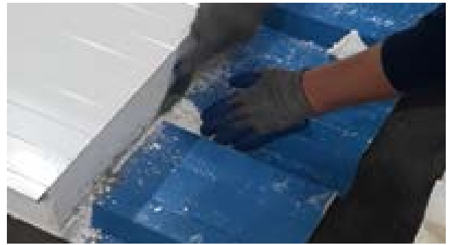
4 Retirar los restos del núcleo que quedaron en la cresta con ayuda de una espátula
