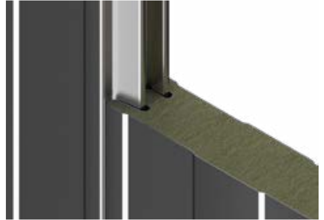
Modus Fijación Vista en posición horizontal. Chequear la correcta posición para evitar filtraciones.
