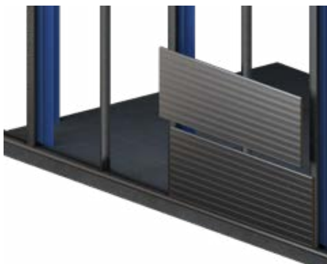
Colocación del siguiente panel hasta completar la altura total del cerramiento.
