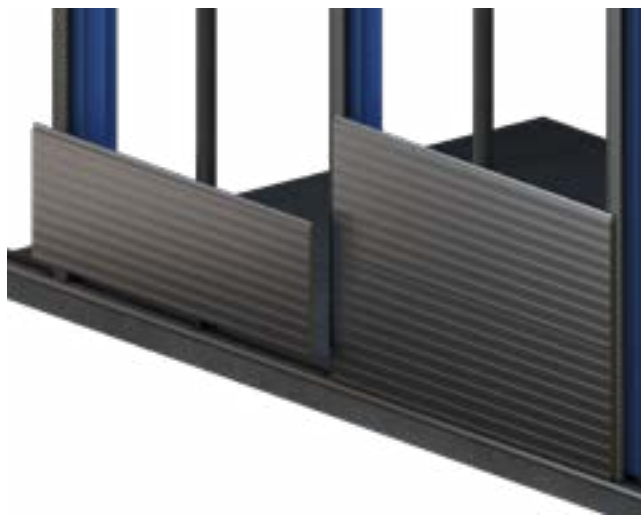
Colocación del primer panel del siguiente tramo de fachada.
